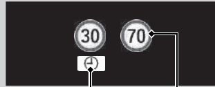
Doplňující dopravní značka rychlostního limitu v závislosti na podmínkách* 2 Dopravní značka rychlostního limitu
